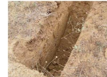
Fouille de sondage
